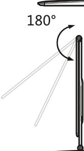
Orienter l'armature dans l'inclinaison souhaitée, en maintenant le pied.
